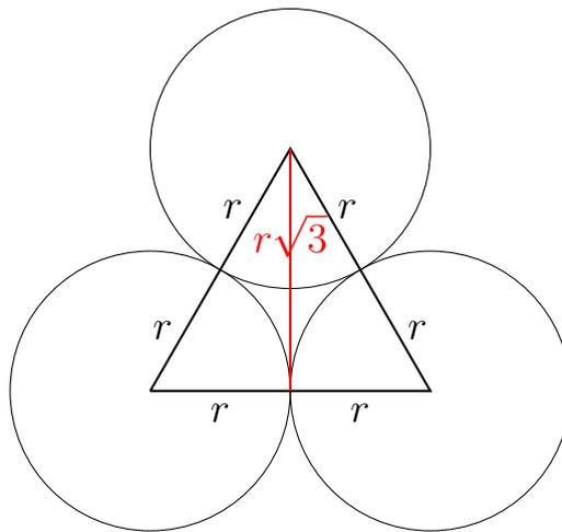
On peut lire sur ce dessin que la surface occupée par les disques est  $\frac{\pi}{2}r^2$  dans chaque triangle équilatéral du réseau, soit une fraction de surface occupée
